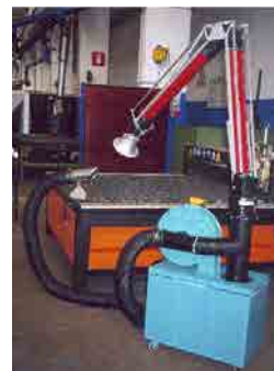
SALDEPUR AP100 composto da gruppo Saldepur base con motore trifase e da braccio aspirante ø 100 mm lungo 2 mt.
